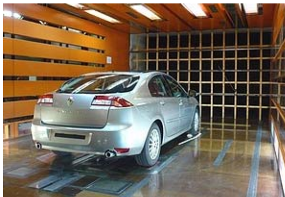
Фиг. 9. Работна част на аеродинамичния тунел на аеротехническият институт в г. Сен Сир-Франция [5]
