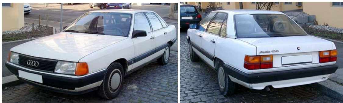
Фиг. 16. AUDI 100 C3 – създаден с оптимизация на формата през 1983 г. - C_x=0,30 .
