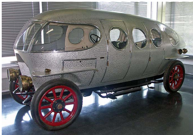
Фиг. 3. A.L.F.A. 40-60 HP с каросерия Castagna Aerodinamica от 1914 – 139 km/h. [1]
