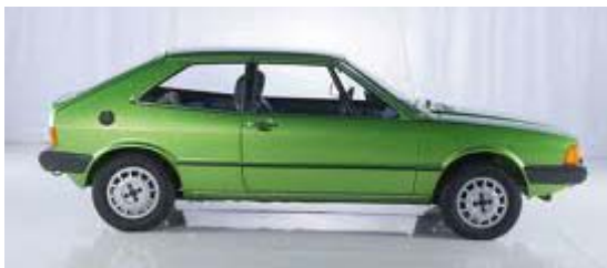
Фиг. 14. VW „Scirocco” – създаден чрез детайлна оптимизация през 1974 г. - C_x=0,41 .
