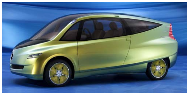
Фиг. 16. Концептуален модел „Mercedes Bionic” от 2005 г. – C_x=0,19 .
